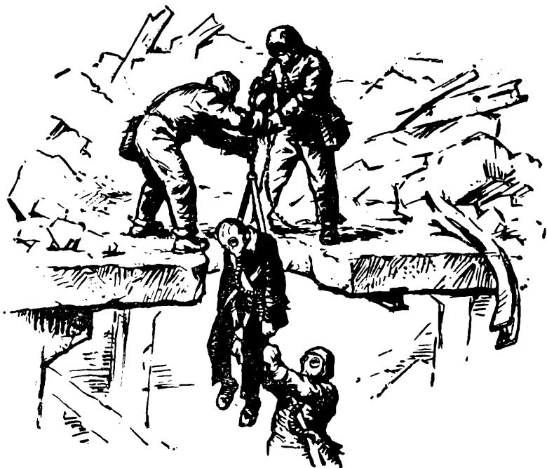
Фиг. 61. Повдигане на пострадал с помощта на носачески колани и въжета през пробит отвор в покритие
