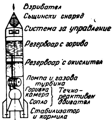
Фиг. 1. Принципно устройство на ракетата
